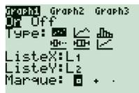
Lorsque les paramètres sont choisis, appuyez sur la touche **[fenêtre]** pour définir les paramètres de la fenêtre de tracé.
